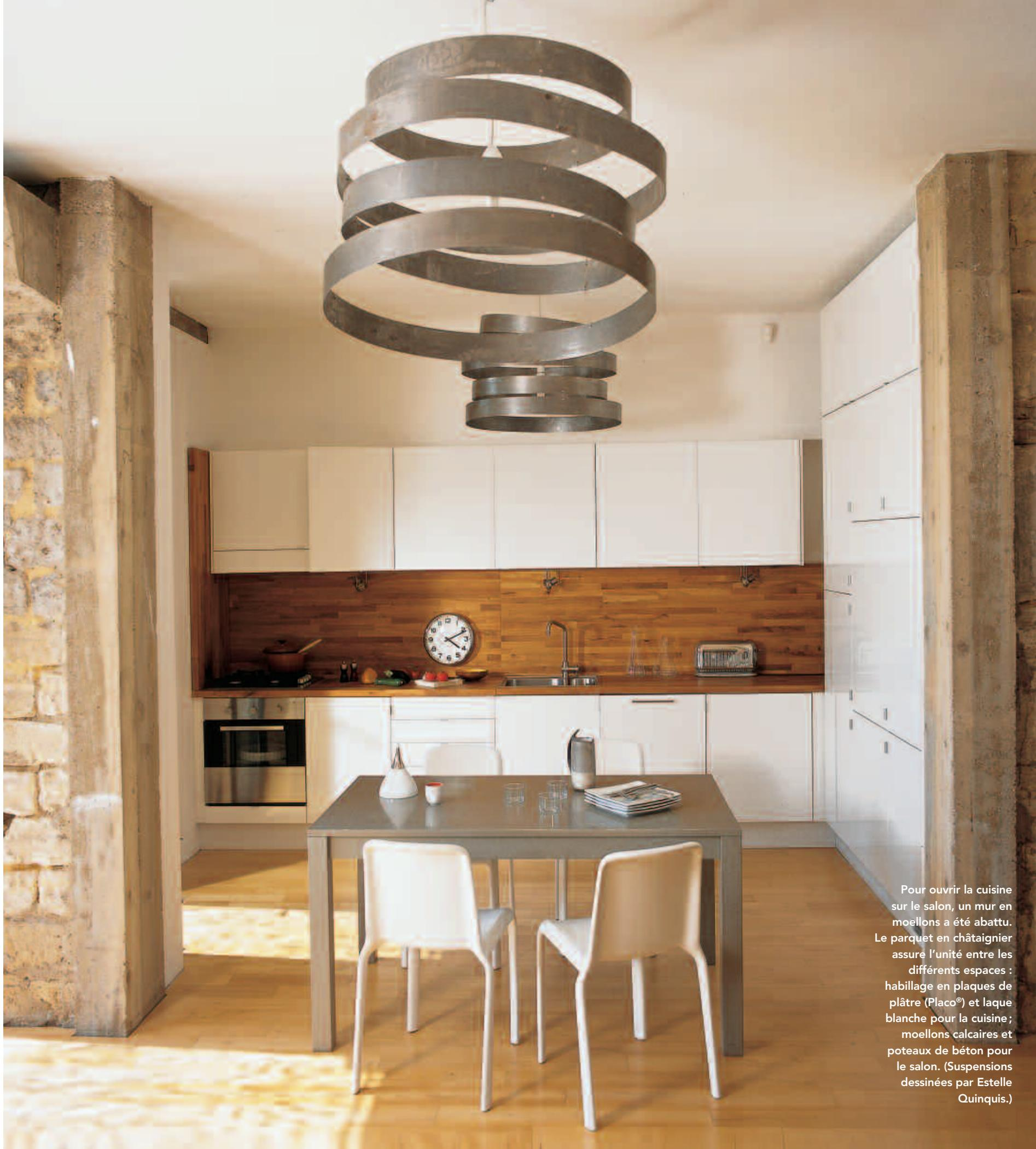
Pour ouvrir la cuisine sur le salon, un mur en moellons a été abattu. Le parquet en châtaignier assure l'unité entre les différents espaces : habillage en plaques de plâtre (Placo®) et laque blanche pour la cuisine ; moellons calcaires et poteaux de béton pour le salon. (Suspensions dessinées par Estelle Quinquis.)
