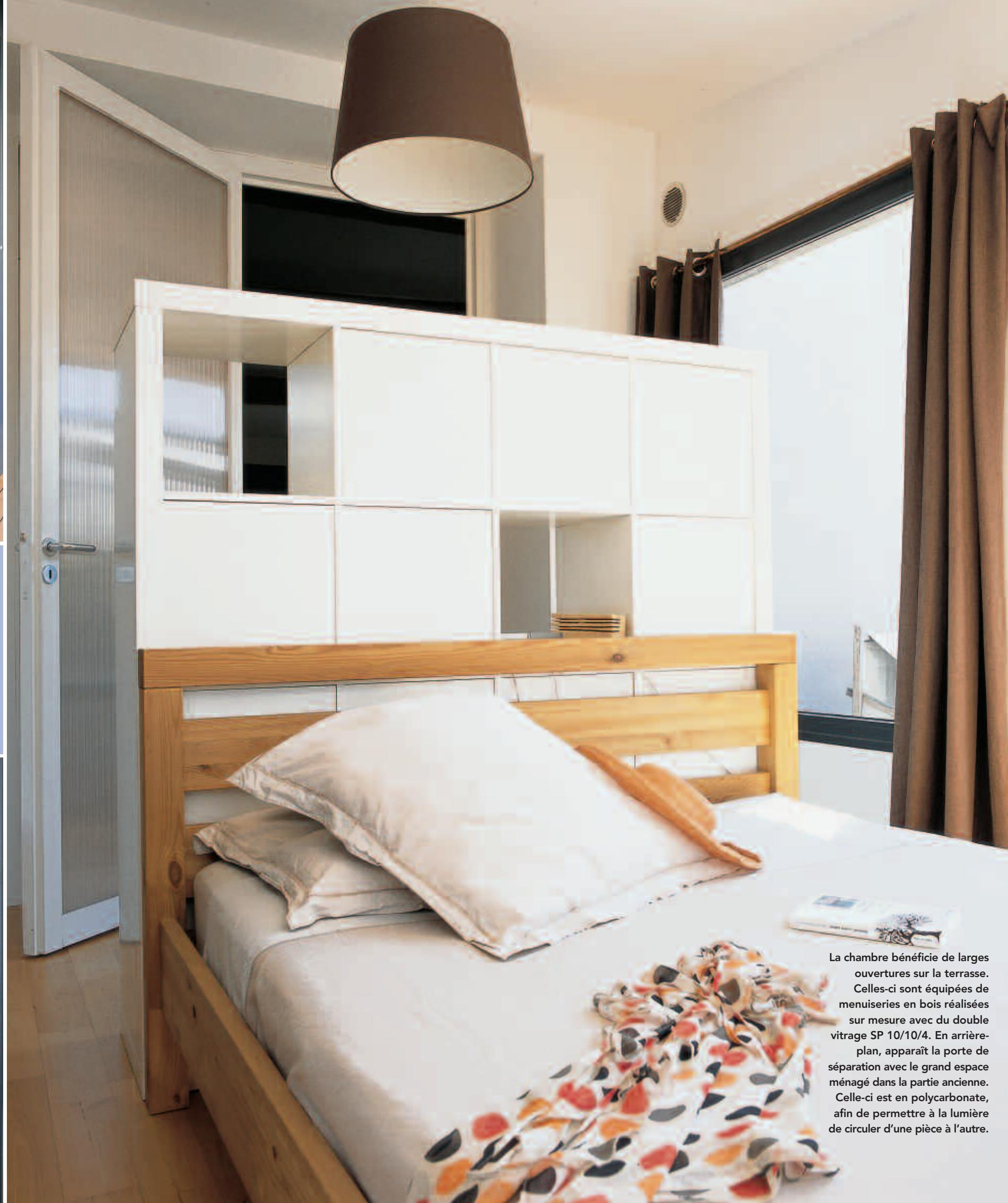
La chambre bénéficie de larges ouvertures sur la terrasse. Celles-ci sont équipées de menuiseries en bois réalisées sur mesure avec du double vitrage SP 10/10/4. En arrière-plan, apparaît la porte de séparation avec le grand espace ménagé dans la partie ancienne. Celle-ci est en polycarbonate, afin de permettre à la lumière de circuler d'une pièce à l'autre.
